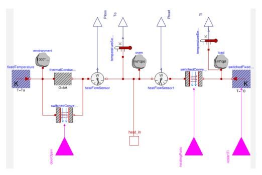
• verwendet neue Komponenten SwitchedConvectionRadiation und SwitchedFixedTemperature
