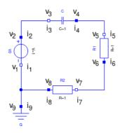
das Gleichungssystem auf und erzeugen Sie mit dem Tarjan- Algorithmus daraus eine Zuweisungskette. Vereinfachen Sie die dabei auftretende algebraische Schleife mit dem Tearing-Verfahren und bestimmen Sie die Bewegungsgleichung.
