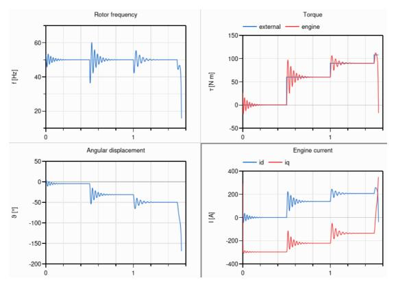
Motorströme im d/q-System im Gleichgewicht konstant
